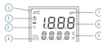
1. Индикатор ATC (Автоматическая компенсация температуры)
